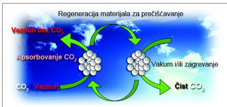
Слика 12: Процес уклањања угљен-диоксида из ваздуха помоћу материјала Полиетиленимин
